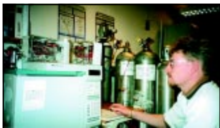
Luftprover från DESCARTES-instrumentet analyseras med hjälp av gas-kromatografi. Foto: Hans Nilsson
